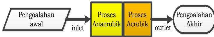
**Gambar 4. 6 Skema Pengolahan Air Limbah dengan Kombinasi Proses Anaerobik dan Aerobik**
